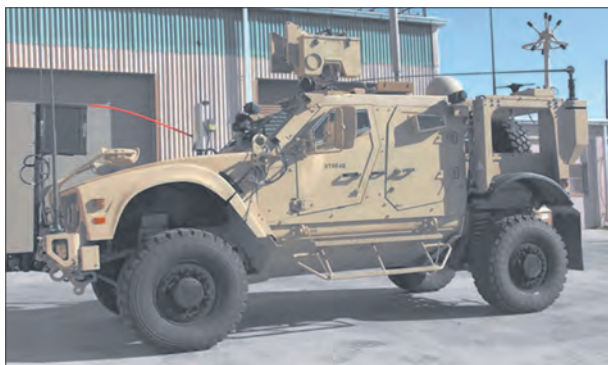
Подвижный узел связи роты «Сне» на базе тактического автомобиля М-АТV
